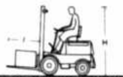
11. Старые погрузочные площадки в настоящее время заменяются автопогрузчиками, длина вылета которых 800-1400 мм
