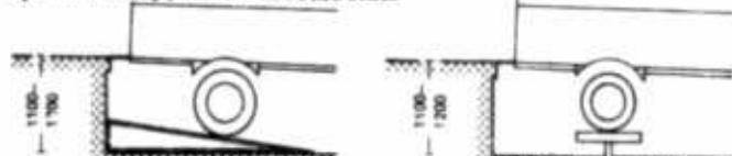
1. Стационарные или передвижные наклонные мосты
