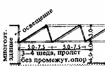
1. Поперечный разрез покрытия с фермами в плоскости остекления фонарей-шедов
