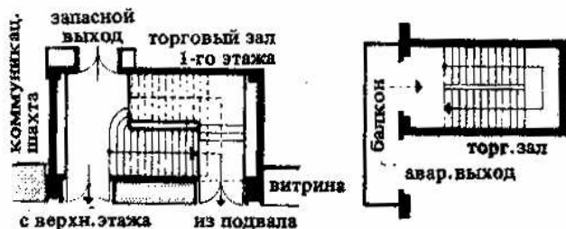
1. Устройство раздельных выходов из подвала и верхнего этажа в одной лестничной клетке
