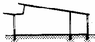
4. Высоко расположенный односторонний верхний свет. Бетонные козырьки предохраняют от прямой инсоляции
