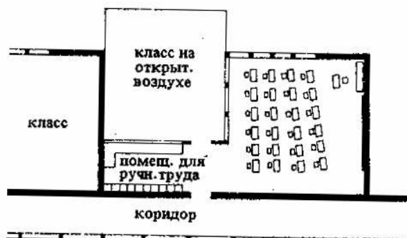
2. Блок, состоящий из класса, класса на открытом воздухе и помещения для ручного труда. Типовое решение. Архит. Нейтра
