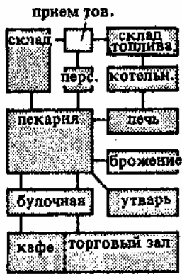
1. Схема планировки булочной-пекарни. Требуется хорошее проветривание, иногда устраивается искусственная вентиляция
