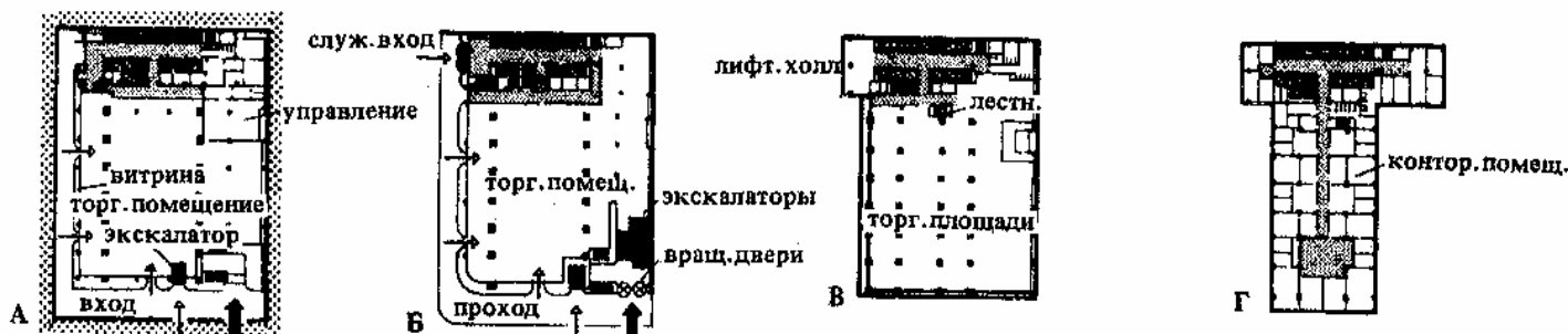
15. Планы этажей ступенчатого 33-этажного здания (США)
