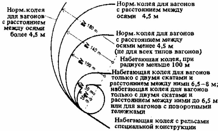
1. Радиусы кривых подъездных железнодорожных путей. В новом строительстве следует избегать применения радиусов менее 100 м. М.: БНН
