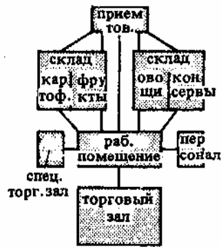
5. Схема планировки овощного магазина. Небольшой склад, рассчитанный обычно на хранение дневного запаса
