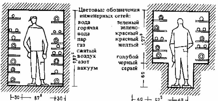
7. Сечения проходных магистральных коллекторов различных; их габариты зависят от числа проходящих трубопроводов
