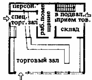
6. Планировка овощного магазина. Рабочее помещение оборудовано машинами для чистки овощей и приготовления полуфабрикатов
