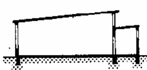
5. Наклонное положение покрытия более благоприятно, поскольку свет распределяется равномернее, чем в здании с горизонтальным перекрытием (рис. 3)
