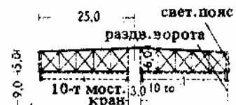
10. Кислородное покрытие длиной 100 м на трех опорах (расстояние между опорами по 30 м)
