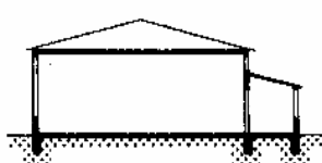
3. Для равномерности освещения помещения предусматривается дополнительный подсвет в противоположной стене
