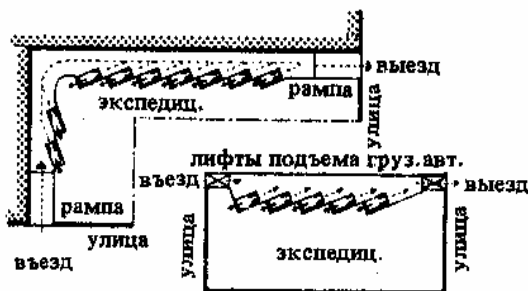
12. Возможности подъезда к подвальным помещениям многоэтажного универмага по рампам и с использованием лифта для грузовых автомобилей. М 1:2000
