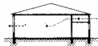
2. Сквозное проветривание при наличии вентиляционных проемов над коридором
