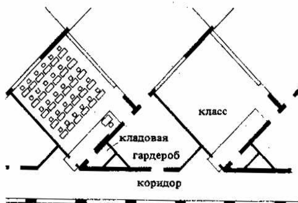
4. Класс дополнительно освещен сзади через высоко расположенное окно, недоступное для посторонних взглядов. Расширение коридора перед каждым классом, используется для размещения гардеробной и кладовой. Архит. Карбонара
