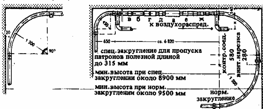
7. Диаметры закруглений и вертикальные размеры трубопроводов пневматической почты. Центральное управление переводом стрелок и управление с помощью самих патронов
