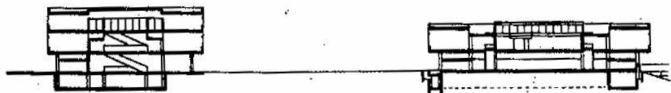
1. Поперечный разрез школьного здания (с. 270) с обозначением уровней этажей. Положение групп помещений на уровнях этажей С и D (см. с. 270 рис. 1 и 2)
