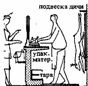
6. Массивный прилавок с рабочей поверхностью, облицованной мрамором или керамической плиткой.
