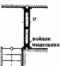
30. Дверной проем заделывается легкими строительными плитами с заполнением между ними
