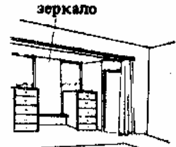
16. Перегородка и пониженный потолок в оконной нише находится на одном уровне; при задернутых занавесках образуется закрытое помещение для переодевания (рис. 14, 15)
