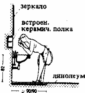
4. Умывальник в стальной комнате, заглубленный водонепроницаемый пол на площади 90 x 90 см из керамических плиток, по возможности с тропом
