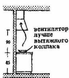
13. При отсутствии специальной вытяжки воздух, насыщенный продуктами сгорания и парами, отходит по каналу к окну в широкую створку. Справ разрез?
