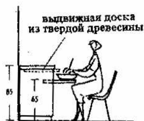
5. В кухне следует предусмотреть место для работы сидя. Лучше всего установить выдвижную доску под локотком рабочего стола; сверху устраивается выдвижная доска для резки продуктов
