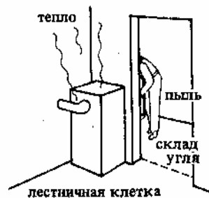
7. Котел может быть установлен в лестничной клетке с топкой из подвального помещения; при этом нмз остается в подвальном помещении, а тепло поступает в лестничную клетку
