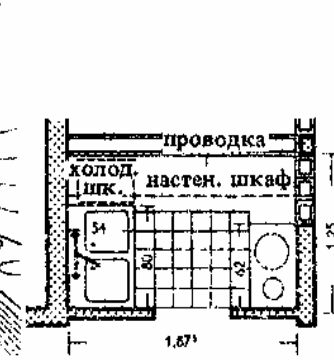
3. Миниатюрная кухня с вытяжной и приточной вентиляцией (прот. Нойферт). Перспектива и план
