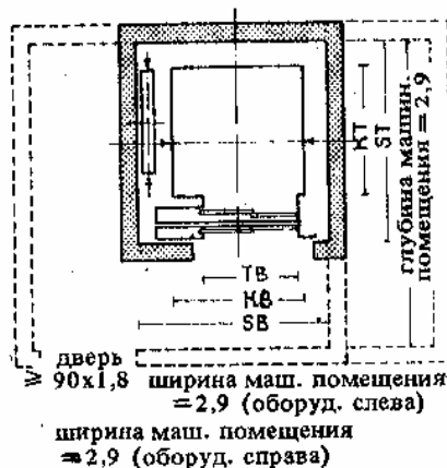
2. Пассажирский лифт с машинным помещением, расположенным над ним
