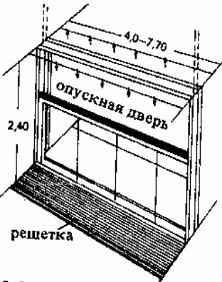
7. Опускная дверь с воздушной завесой
