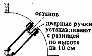
8. Правильное открывание двух дверей, ведущих в одно помещение и расположенных в углу этого помещения
