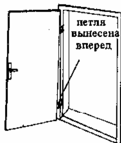
9. Правильно навешенная дверь. При открывании плотно дверь немного поднимается вверх
