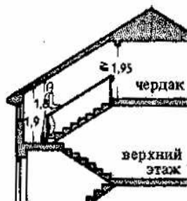
2. При совпадении направлений стропил, балок и лестничных маршей достигается экономия строительного объема здания и упрощается конструктивное решение (размеры в м)
