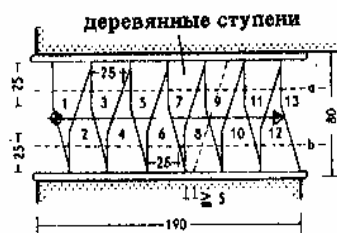
5. План. Ширина ступеней по линиям а и б \geq 20 см
