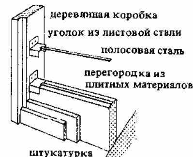
11. Крепление дверной коробки в перегородке
