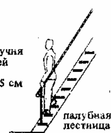
4. Покружные лестницы с перилами имеют ступени 21 x 15 см, без перил до 25 x 30 см
