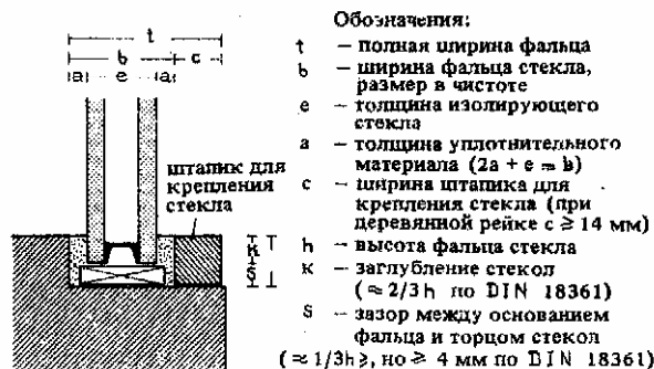
2. Установка изолирующего стекла по DIN 18361
