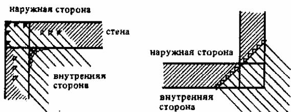
6. На внутренней поверхности наружных углов возникает конденсат
