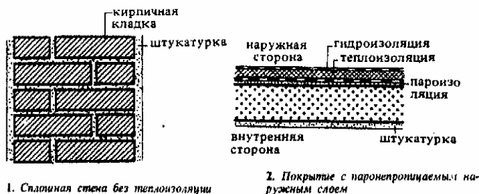
1. Сплошная стена без теплоизоляции
