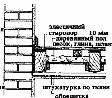
9. Звукоизолирующая способность против ударного шума перекрытия по деревянным балкам
