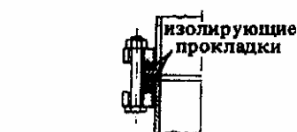
7. Звукоизолирующие прокладки в узле соединения фланцев
