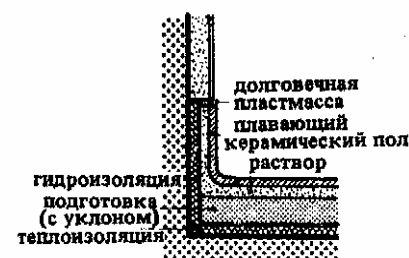
7. Плавающий пол из керамической плитки (аннотация)
