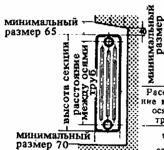
1. Установки и размеры радиаторов (см. табл.)
