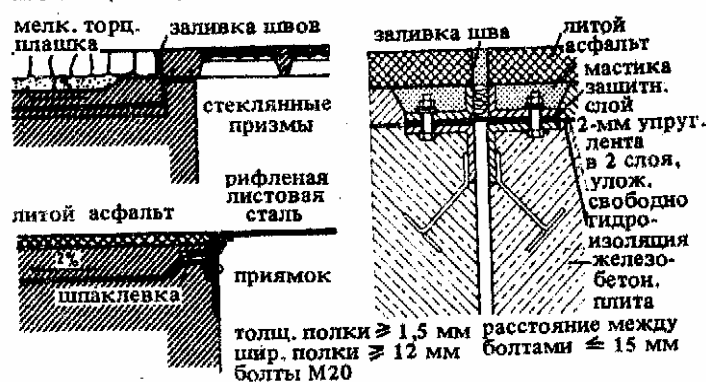
22. Гидроизоляция деформационных швов в железобетонных перекрытиях
