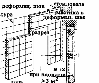
12. Перегородки из стеклоблоков с арматурой в швах
