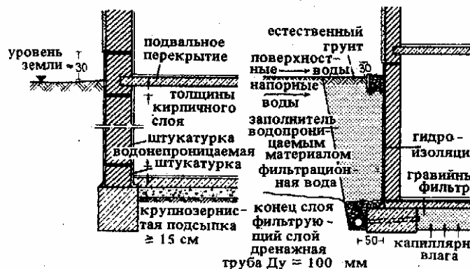
7. Простые случаи устройства сухих полов и гидроизоляции, когда подвальное перекрытие находится на уровне земли
