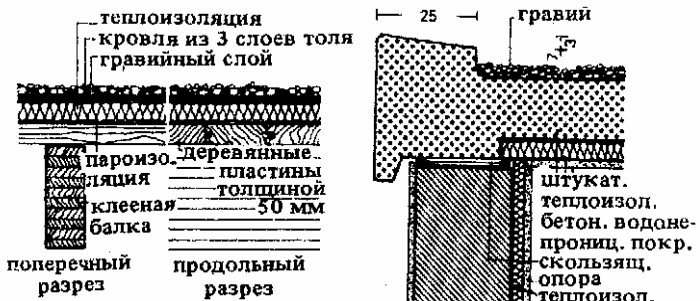
1. Теплая кровля с клееными балками. С внутренней стороны — обшивка стропильными пластинами
