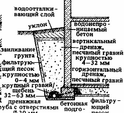
14. Трубчатый дренаж со ступенчатым фильтром
