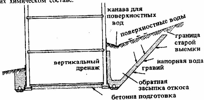
15. Стены подвалов с напорной стороны должны быть тщательно изолированы
