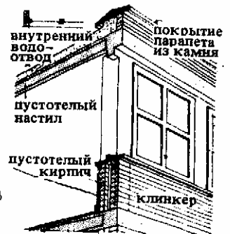
6. Железобетонное каркасное здание с подоконным поясом, прикрывающим наружные колонны на половину толщины
