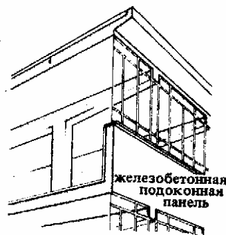
7. Железобетонное здание с целостным и экономичным консольным решением покрытия со сплошным лепточным остеклением
