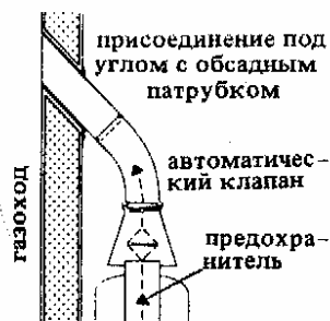
2. Предохранитель и клапан на патрубке присоединения прибора
